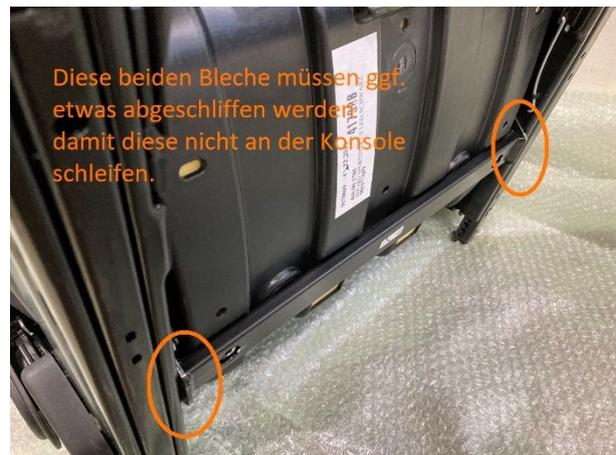
Diese beiden Bleche müssen ggf. 1 – 3 mm abgeschliffen werden, damit diese nicht an der Konsole schleifen.
