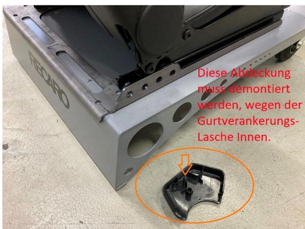
Diese Abdeckung muss demontiert werden, wegen der Gurtverankerungs-Lasche innen.
